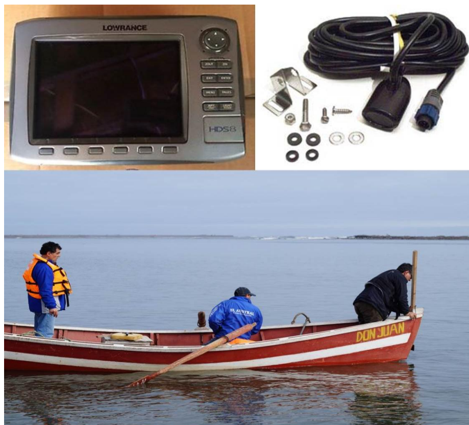
Figura 8. Instalación del transductor del ecosonda LOWRANCE HDS-8m en la embarcación de muestreo.
